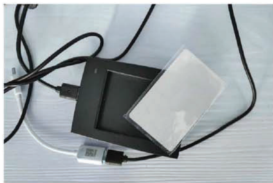
图 2 高频 13.56M 射频卡读写器
