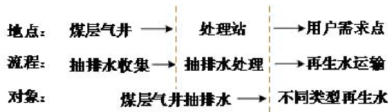
图 1 煤层气井抽排水的回收利用
